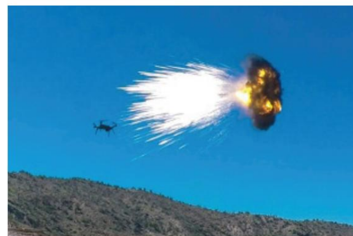
Kinetic CUAS using airburst munition
